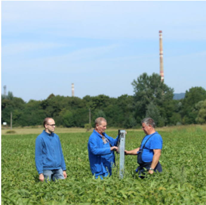
Meranie penetrometrickeho odporu pôdy na variantoch pokusu v poraste sóje fazuľovej, hlavný pokus, 14. september 2021.
