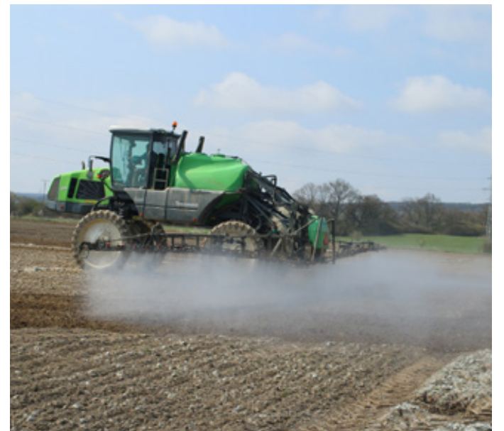
Aplikácia tekutého preparátu firmy CE Invest vo vysokej dávke veľkoplošným postrekovačom na povrch pôdy s bezprostredným zapravením do pôdy, hlavný pokus, 21. apríl 2021.
