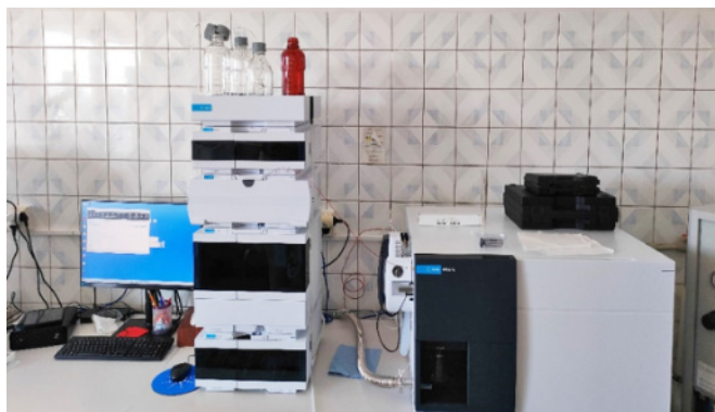
Nový separačný systém LC-MS/MS pre analýzu rezíduí pesticídov.
